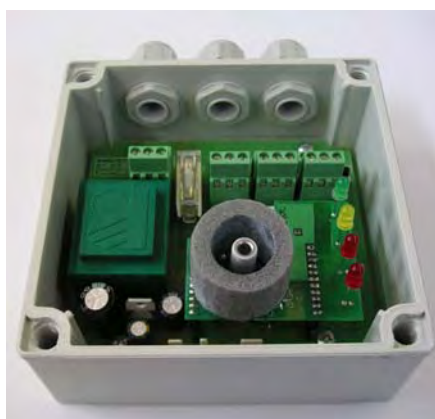
Rys. 2. Widok po zdjęciu pokrywy, pozycja montażowa detektora.
