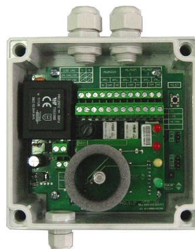
Rys. 2. Widok po zdjęciu pokrywy, pozycja montażowa detektora.
