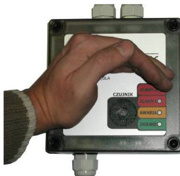
Rys. 6. Daszek powyżej otworów wlotowych przyspiesza reakcję czujnika
